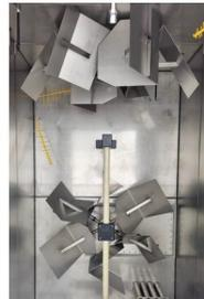
Brasseurs mécaniques à l'intérieur d'une chambre
