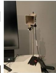
Antenne cornet pour la fréquence 26 GHz
